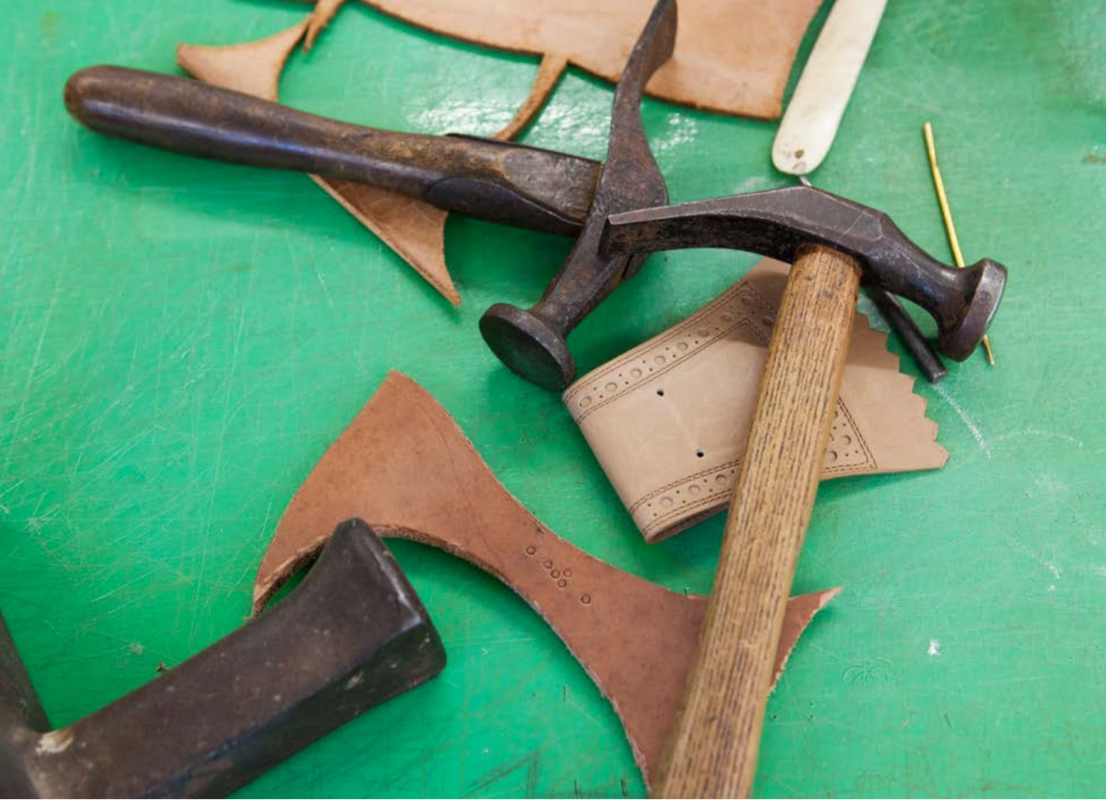
Hämmer, Silberstift, Spitzknochen zum Falzen, Biegen, Polieren und Knicken, Lochpfeife für Ösen oder Verzierungen, Sohlenleder und Colferlasche / Hammers; silver point; pointed horn for folding, bending, polishing and kinking; tool for perforating eyelets or embellishments; sole leather and golf shoe flap
