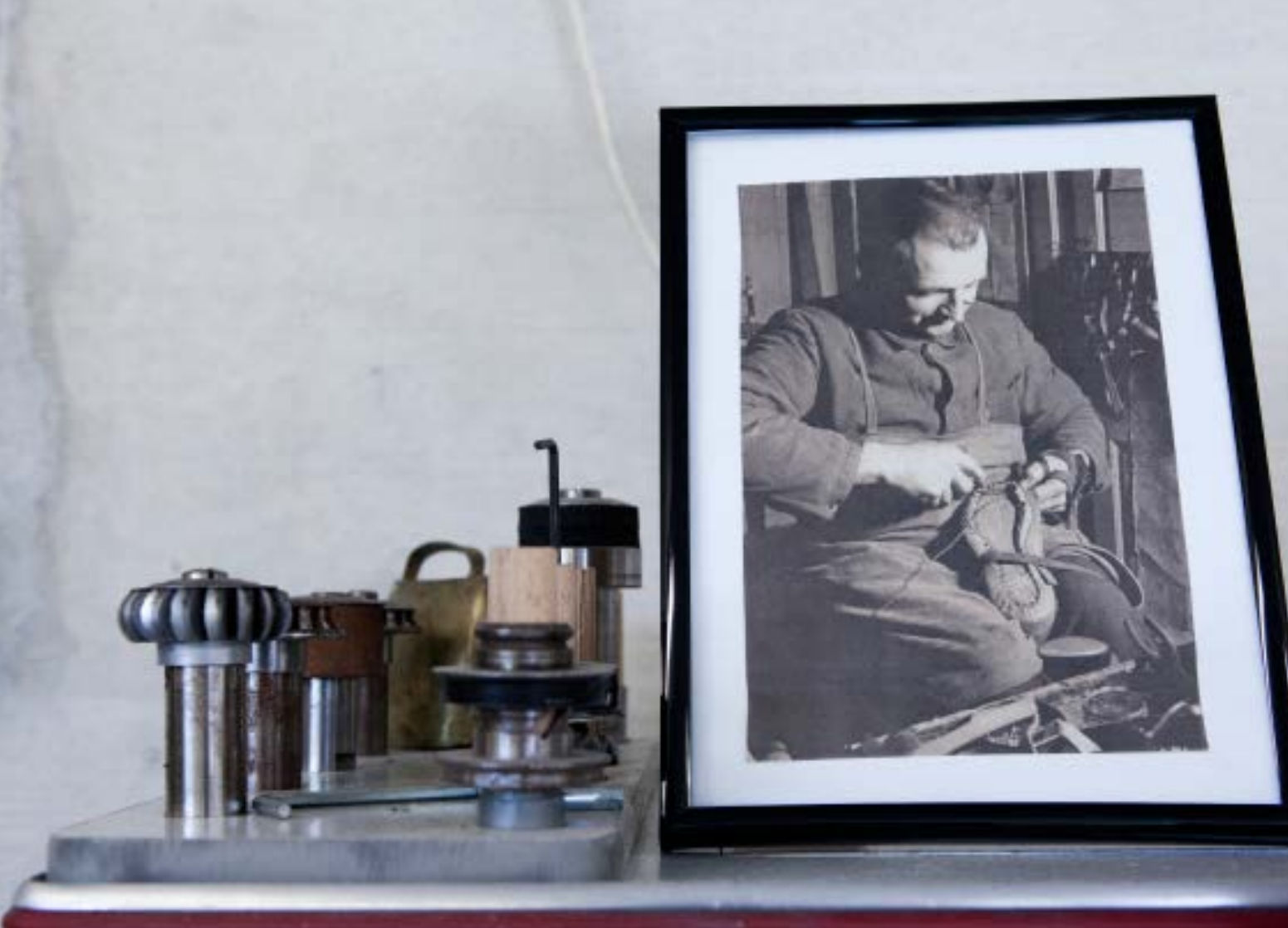
Sohlenfräser und Poliereisen zur Sohlenbearbeitung. Photo: ein rahmengerähter Schuh wird eingestochen / Maschine for trimming and polishing the soles. Photo: a welted shoe is being pierced. Unten: Detail einer Freiarml-Eledernähmaschine / Below: Detail of a free-arm leather sewing machine
