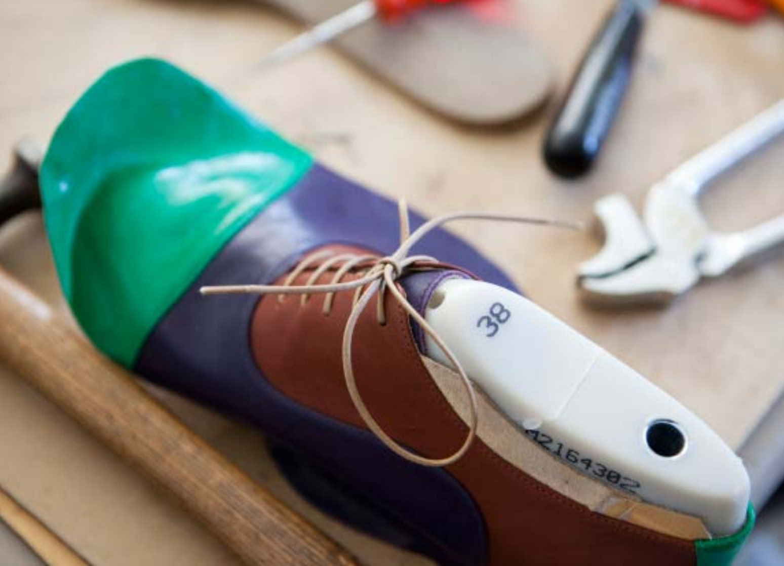
Schuh-Prototyp, Zwickzange zum Ziehen des Schafts über den Leisten, Tackelheber zum Rausziehen der Nägel, Rundhölle und Hammer / Shoe prototype: lasting pincers for pulling the upper over the last; tack puller for pulling out nails; round awl and hammer Modell Palermo multicolore / The "Palermo multicolore" model
