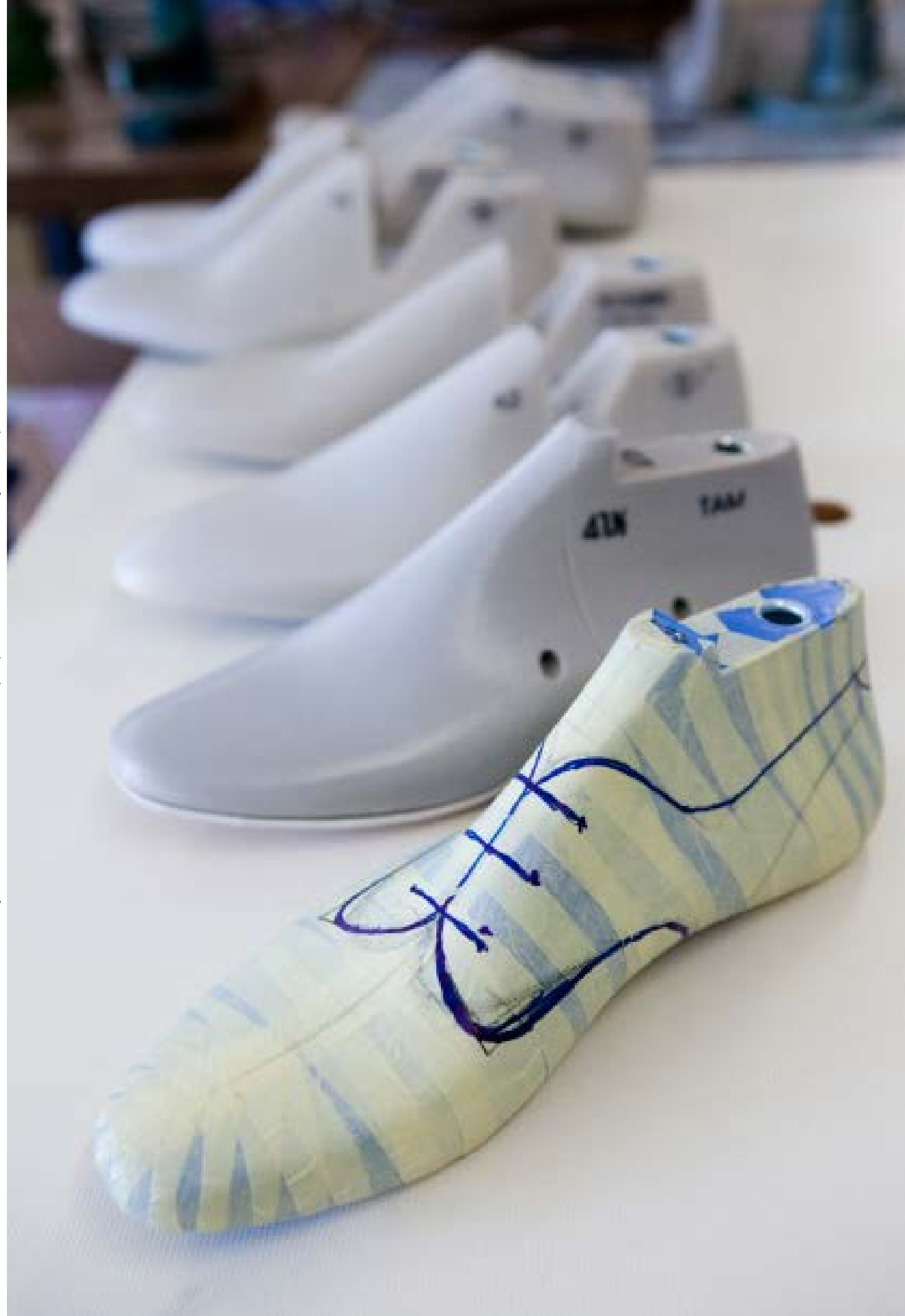
Abgeklebter Herrenleisten: Modellentwurf eines Derbys / Taped last with sketched lines for crafting a men's Derby model
